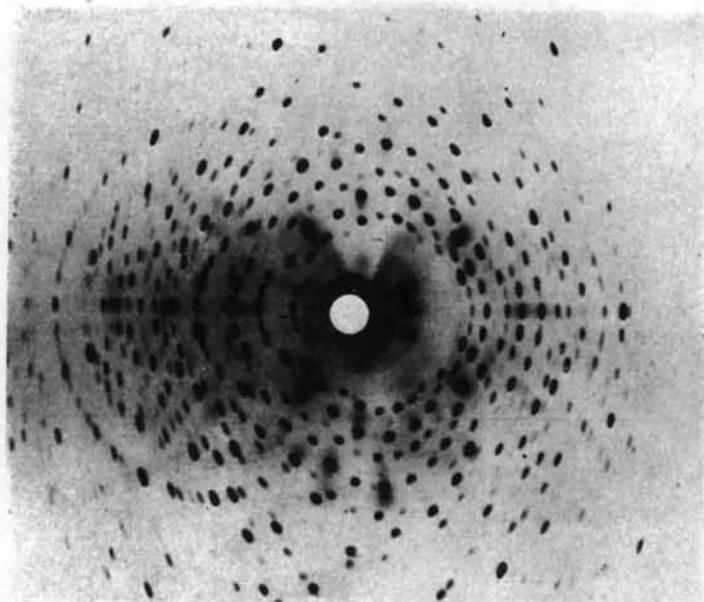
Diagramme de Laue de  $\text{ClO}_3\text{Na}$  montrant les réflexions diffuses. Anticathode de Mo—37 kV.; 14 mA.—7 heures de pose.—Film cylindrique  $R=29$  mm.—Angle du rayon incident avec  $[010]=4,4^\circ$ ; avec  $[100]=90,5^\circ$ .
